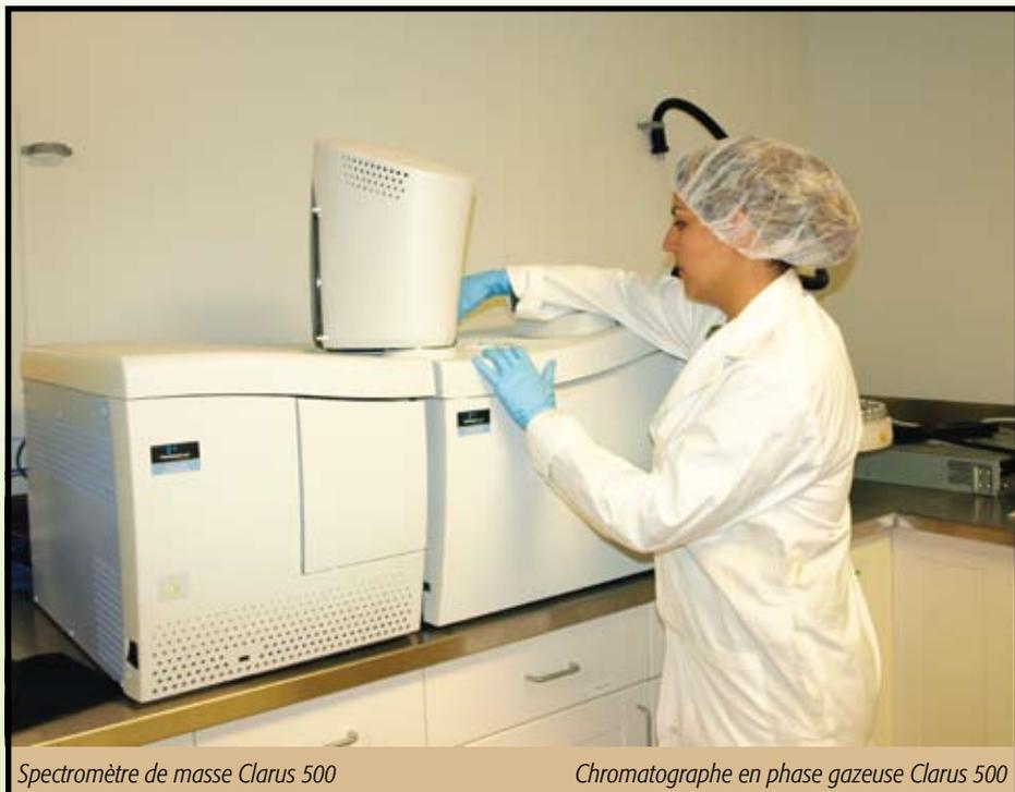
Spectromètre de masse Clarus 500
